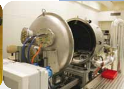
DEVELOPPEMENT D'UNE CHAMBRE VIDE-THERMIQUE POUR EQUIPEMENTS
