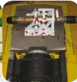
OUTILLAGE D'ESSAIS DE VIBRATION SUR TORPILLE
