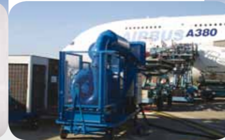
MOYEN DE VENTILATION POUR TEST D'UN SYSTEME D'EXTINCTION SUR TURBORÉACTEURS
